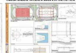
Nei primi due riquadri, gli interventi per il drenaggio e l'impianto di irrigazione sul terreno di gioco. Negli altri, nell'ordine, il rifacimento delle aree per i lanci del disco e martello, peso, salto con l'asta, fossa sabbia e salto in lungo
